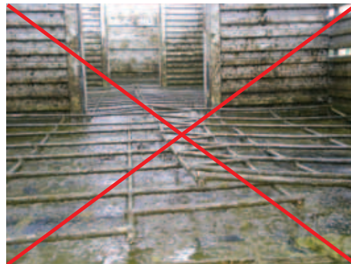
CAMINHÃO COM GRADES TORCIDAS E QUEBRADAS
